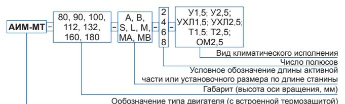
ТЕХНИЧЕСКИЕ ПАРАМЕТРЫ ЭЛЕКТРОДВИГАТЕЛЕЙ АИМ-МТ 80-200, напряжение 380/660 В
